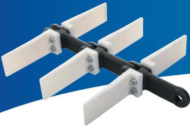
Die Glieder der Gabelkette von VAV werden aus unterschiedlichen Qualitätsstählen geschmiedet und anschließend dem Werkstoff entsprechend im Einsatz gehärtet oder vergütet. An den einzelnen Gliedern können diverse Arten von Mitnehmern aus Kunststoff montiert und / oder Stahl geschweißt werden. In der Übersicht finden Sie zu unseren Ausführungen, die Hinweise zu Bruchlasten und überwiegend lagernden Materialqualitäten.
