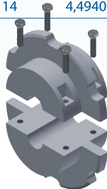
Geteiltes Kettenrad für den leichten Einbau
