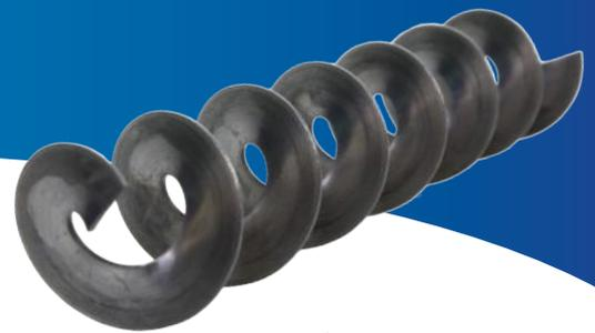
Die Schneckenspiralen werden aus einem Stück gewalzt. Hierbei ist zu beachten, dass aufgrund des Walzprozesses die Wandstärke im Bereich der Bohrung die doppelte Stärke beträgt als an der Außenseite. Die Standardlänge der Schneckenspirale beträgt ca. 3.000 mm und sind in folgenden Materialien teils aus Vorrat lieferbar: S235JRG2 und Edelstahl 1.4301, in linker oder rechter Steigung.
