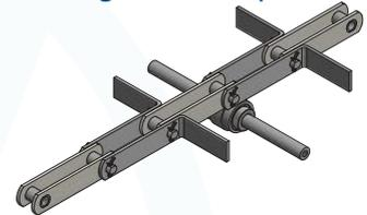
Wir bieten Ihnen zudem die Rücklaufrollen nach Ihren Vorgaben gern an. Die Rollen können aus unterschiedlichen Kunststoffsorten wie PE1000 / Nylon / POM oder Stahl wie C45 / 42CrMo4 natur oder gehärtet gefertigt werden. Bei Stahlrollen wird vorzugsweise beidseitig ein abgedichtetes Kugellager eingesetzt. Die Wellen mit Innen- oder Aussengewinde beidseitig versehen.
