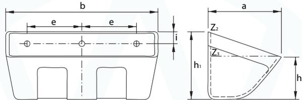
Kunststoffbecher Type M (Abmessungen in mm)
