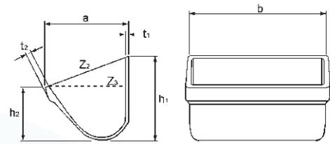
CC-S-Elevatorbecher (Abmessungen in mm)
