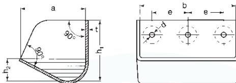
Elevatorbecher aus Stahlblech in der geschweißten Ausführung gemäß DIN 15231 (Abmessungen in mm)
