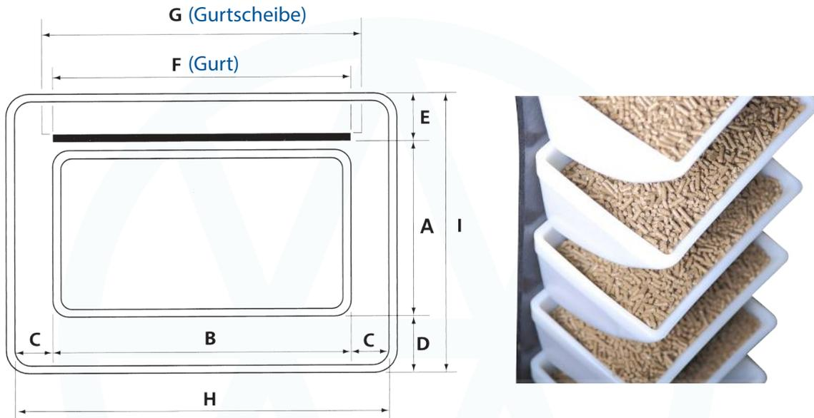
Elevatorgehäusegrößen für die Starco Elevatorbecher
