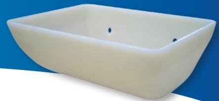
VAV liefert Starco Elevatorbecher aus Kunststoff (HDPE und Nylon) direkt aus Vorrat. Zudem sind auch PU und Zytel erhältlich. Die Elevatorbecher aus Kunststoff eignen sich ferner auch hervorragend für die Förderung klebriger oder fettiger Produkte. Ein weiterer Vorteil liegt darin, dass die Elevatorbecher aus Kunststoff beim Schiefelauf keine Funken schlagen. PEHD ist temperaturbeständig bis 70 ° C. Der Elevatorbecher aus Nylon ist temperaturbeständig bis 90 ° C.
