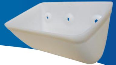
Die Columbus Elevatorbecher aus Kunststoff eignen sich besser als Stahl für die Förderung feuchter oder klebriger Materialien und sind in zwei Ausführungen erhältlich. Die weiße Polypropylenausführung kann Höchsttemperaturen von 60 °C aushalten. Der grüne Columbus Elevatorbecher aus Nylon (Kunststoff) ist hitzebeständig bis zu einer Höchsttemperatur von 90 °C. In der nachstehenden Tabelle sind die Standardgrößen der Columbus Elevatorbecher aus Kunststoff aufgeführt.
