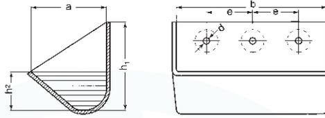
Elevatorbecher aus Stahlblech in der geschweißten oder gepressten Ausführung gemäß DIN 15233
