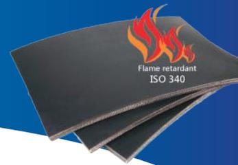
NBR Schwer entflammbare (ISO 340) Elevatorgurte sind antistatisch (ISO 284). Die Gewebereinlagen bestehen aus einer Kombination aus Polyester und Nylon. Das Elevatorgummi wird aus NBR (Nitril-Butadien-Kautschuk) hergestellt. Die Gurtoberfläche ist hervorragend dazu geeignet, dass sich die Tellerschrauben in den Gurt einziehen können.
