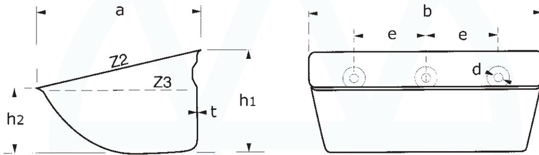
Starco Elevatorbecher aus Stahl / Edelstahl (Abmessungen in mm)
